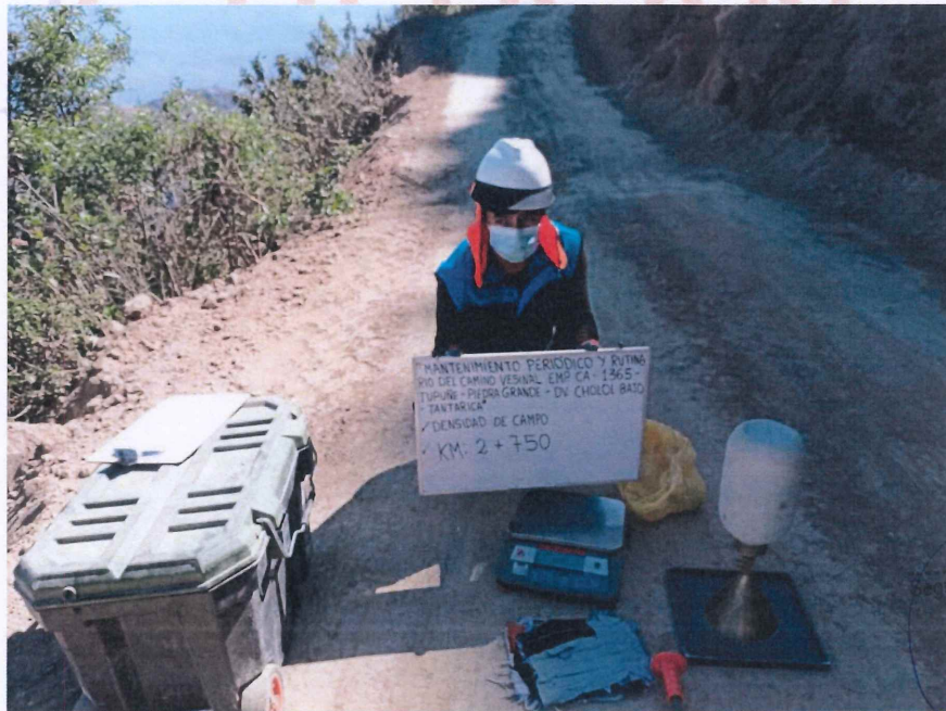
FIGURA N° 12. Ensayo de Densidad de Suelo en Campo. Progresiva 02 + 750 (Método del cono de arena).
