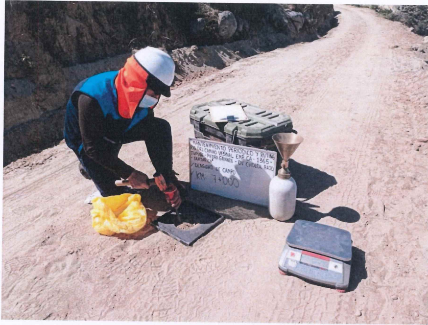
FIGURA N° 29. Ensayo de Densidad de Suelo en Campo. Progresiva 07 + 000 (Método del cono de arena).
