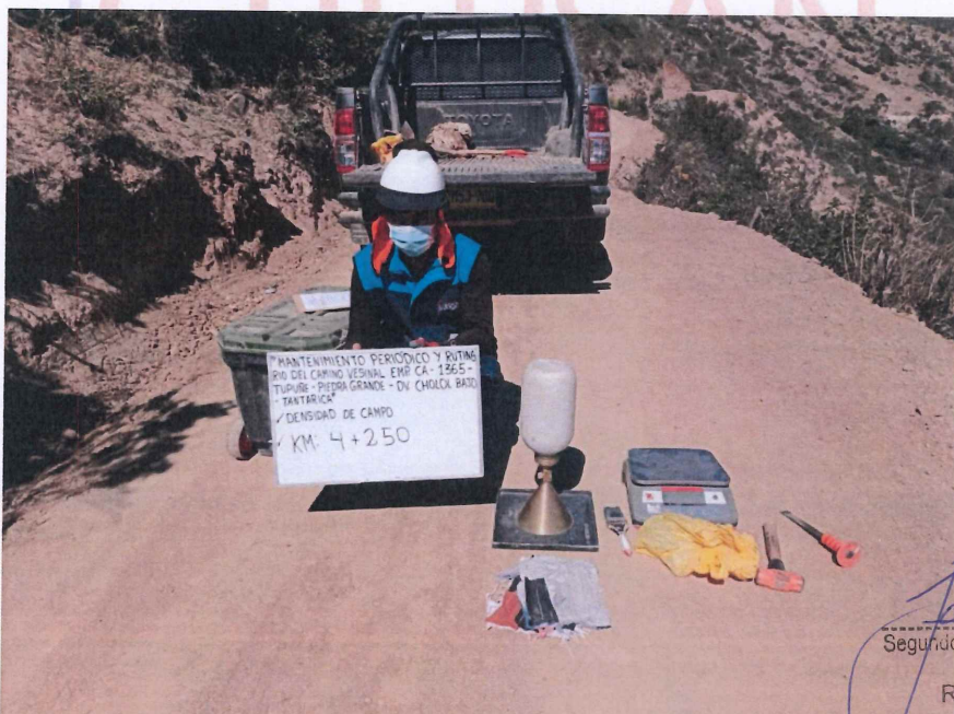
FIGURA N° 18. Ensayo de Densidad de Suelo en Campo. Progresiva 04 + 250 (Método del cono de arena).
