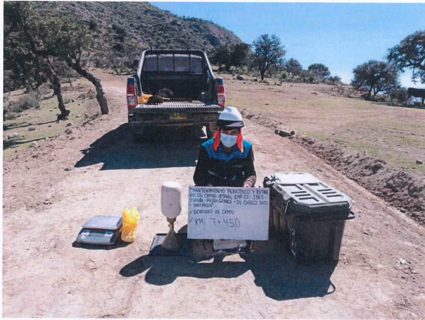
FIGURA N° 31. Ensayo de Densidad de Suelo en Campo. Progresiva 07 + 450 (Método del cono de arena).
