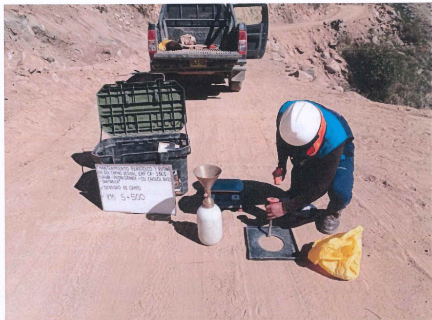
FIGURA N° 23. Ensayo de Densidad de Suelo en Campo. Progresiva 05 + 500 (Método del cono de arena)
